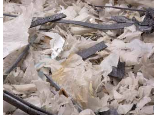
▲ Pvb folie uit gelaagd glas, zoals UpcyGran het krijgt aangeleverd van de recyclingsbedrijven. Voorheen werd dit restafval gestort of verbrand.
